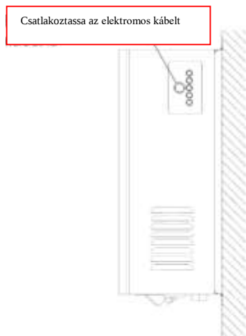
Ábra 8. A kábel csatlakozás elhelyezkedése
