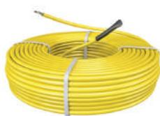
Elektromos fűtőkábel, minimum 5-6 cm vastagságú betonba való telepítésre. Alapvetően főfűtési célra ajánlott, 10, 17 vagy 30 Watt/méter fajlagos hőteljesítményben, 3 méter hosszú tápkábellel.
