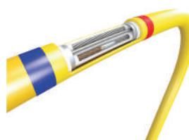
A fűtőszönyegben és önmagában is elérhető fűtőkábel elektromágneses- és érintésvédelemmel is ellátott, 7 mm átmérőjű két-vezetős fűtőkábel, PVC külső köpennyel, 3 méter hosszú tápkábellel. A tápkábel és fűtőkábel egy egyedi csatlakozási módon, gyárilag a kábel belső tokozása alatt megoldott.
